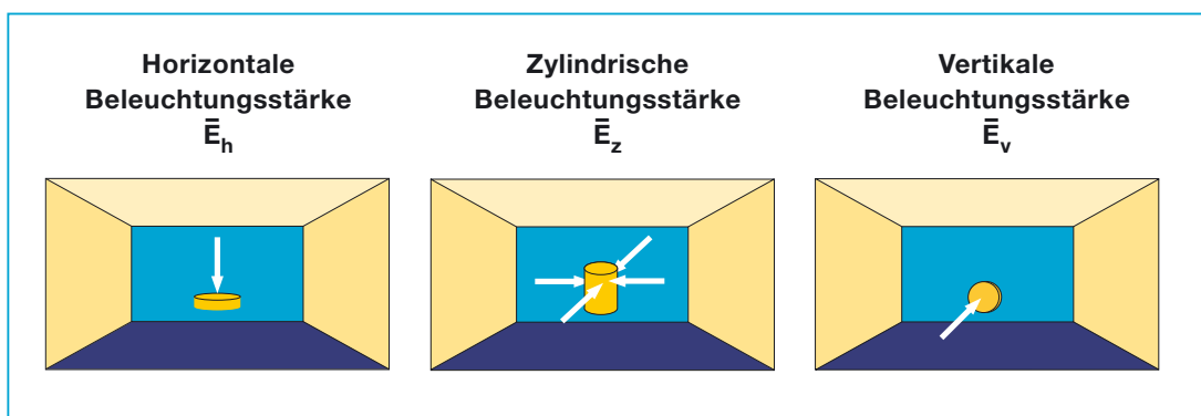
Abbildung 57: Ermittlung der horizontalen, zylindrischen und vertikalen Beleuchtungsstärke (schematische Darstellung)
