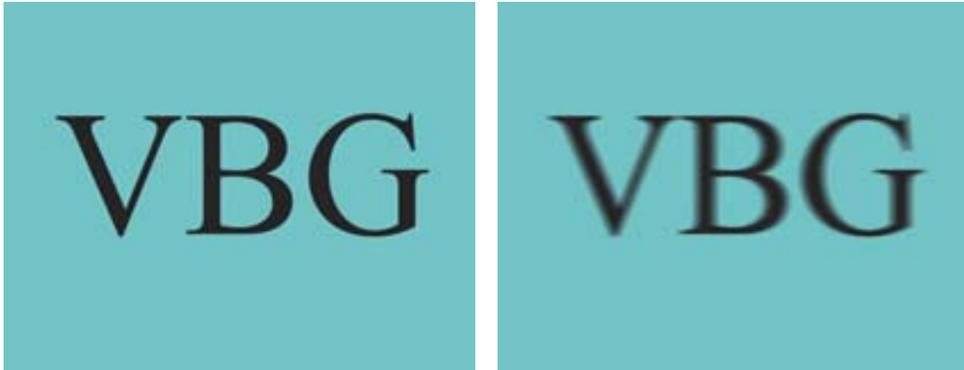
Abbildung 16: Darstellung auf einem LCD-Bildschirm: Links in physikalischer, rechts in kleiner Auflösung
