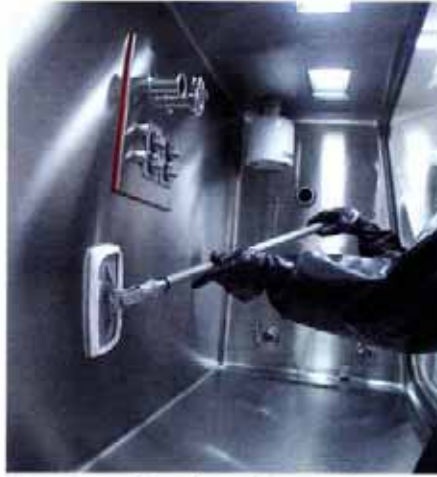
Abb. 5: Anwendung eines Isolatorreinigers (Foto mit freundlicher Genehmigung von Geringe, La Calhene)
