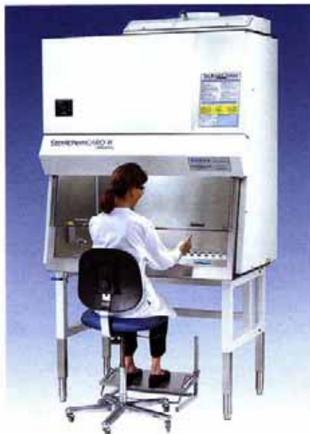
Abb. 3: Mikrobiologische Sicherheitswerkbank (Foto mit freundlicher Genehmigung von The Baker Company)
