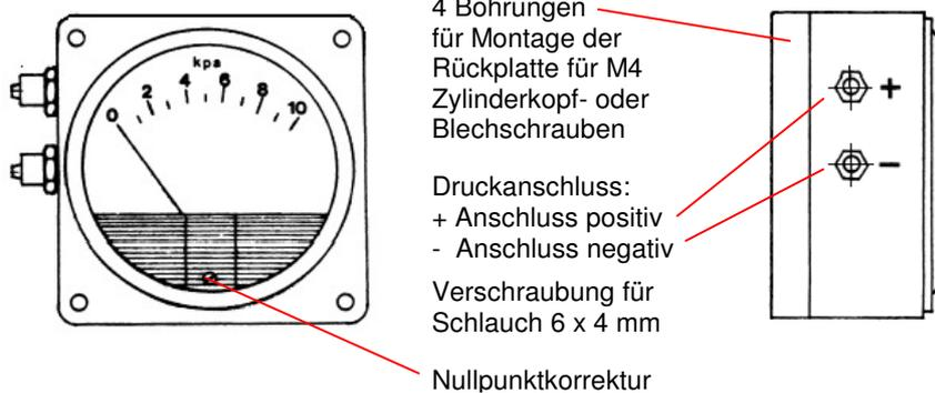
Das zugehörige Kunststoffgehäuse besteht aus zwei Teilen. Im Frontteil ist ein Messgerät mit dem geforderten Messbereich anschlussfertig eingebaut. Das Rückteil ist so gestaltet, dass es ohne Frontteil an die entsprechende Messstelle mit Zylinderkopfschrauben M4 oder Blechschrauben angebaut werden kann. Bei Inbetriebnahme wird das Frontteil mit Messgerät an das bereits montierte Rückteil befestigt.
